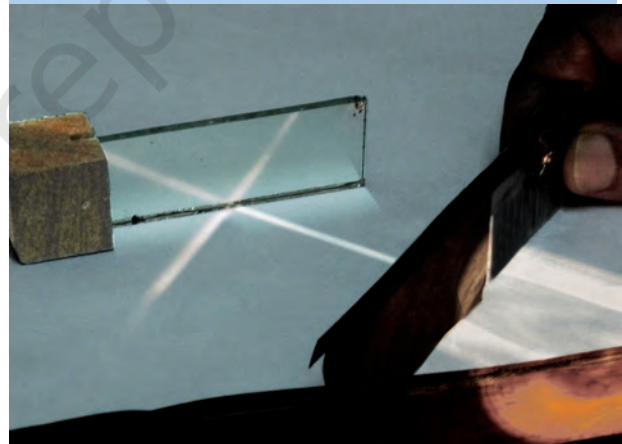
चित्र 16.1 : परावर्तन दर्शाने की व्यवस्था
